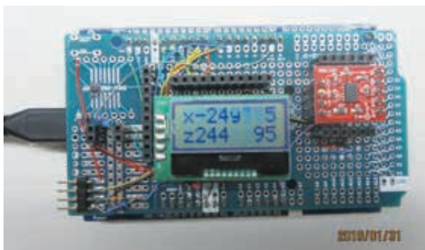
写真4 センサーを装着したマイコンボード
