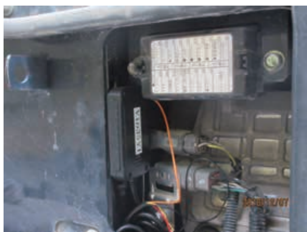
写真7 建設機械のヒューズボックス横にGPSトラッカーを装着
